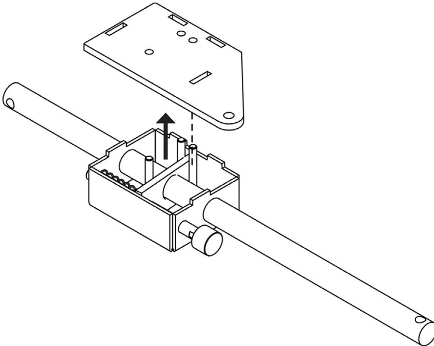
8. Poussez la goupille du système de verrouillage en poussant la plaque de verrouillage vers les deux boulons et retirez l'arbre long du système de verrouillage.
