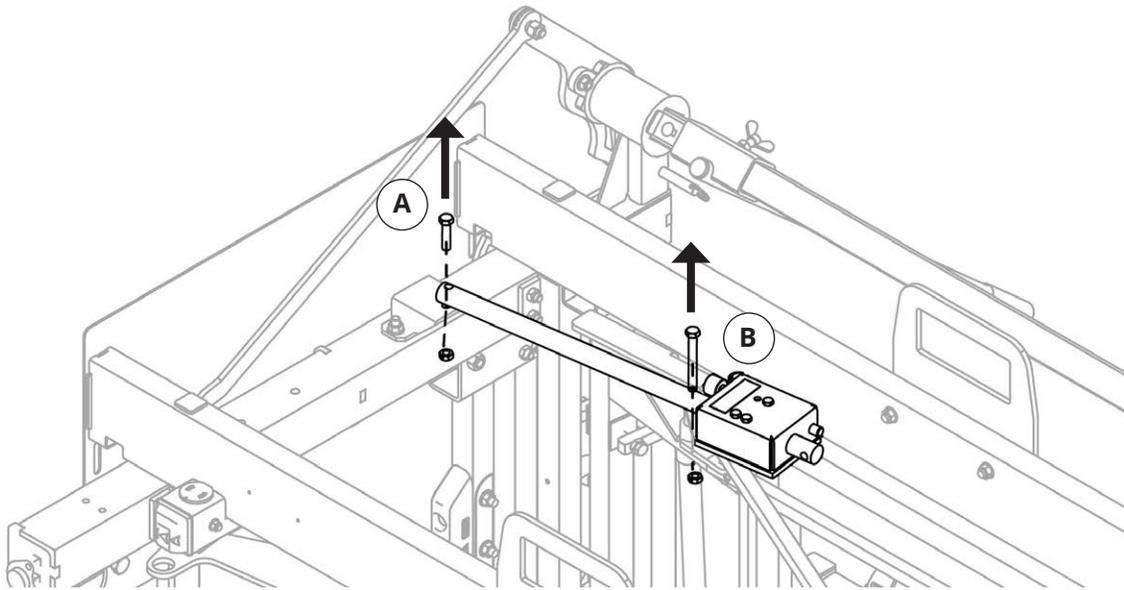
4. Soulevez soigneusement l'ensemble du boîtier de verrouillage hors de la cage de contention et placez-le sur votre surface de travail.
