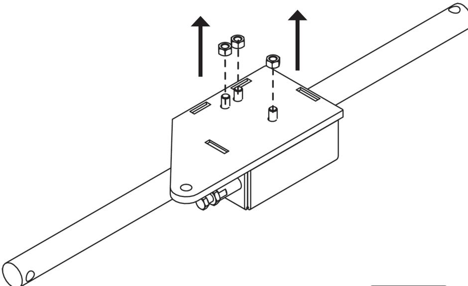
3. Retirez la plaque arrière pour exposer le mécanisme de verrouillage.
