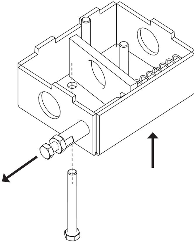
6. Relâchez lentement la pression sur la plaque de verrouillage, puis retirez la plaque de verrouillage, le ressort et le petit arbre du mécanisme.
