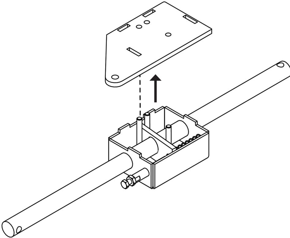
4. Poussez la goupille du système de verrouillage en poussant la plaque de verrouillage vers les deux boulons et retirez l'arbre long du système de verrouillage.
